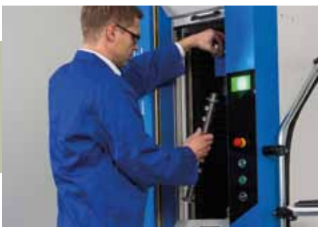
Chargement simple de la machine de mesure grâce au réglage rapide de la contre-poupée
