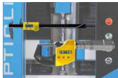
Boîtier d'interface pour les moyens de mesure externes
