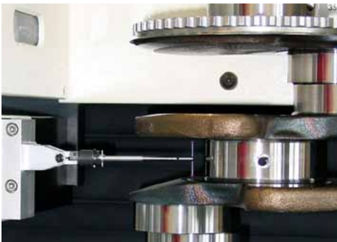
Système de palpation tactile en option pour les longueurs et les battements axiaux concentriques
