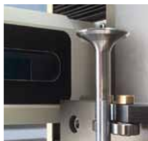
HOMMEL-ETAMIC opticlina VMS305 pour la mesure des soupapes de moteur, intégré dans une installation de fabrication
