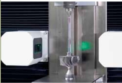
Mesure d'un arbre de turbocompresseur
