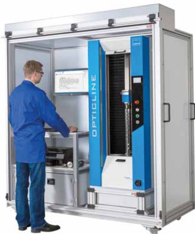
HOMMEL-ETAMIC C914 avec station de travail mobile en option pour une utilisation plus souple sur le lieu de production
