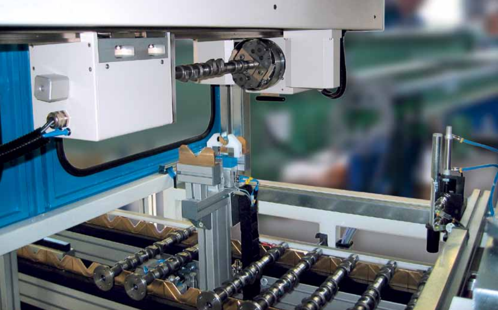
HOMMEL-ETAMIC optiline CA610H intégré à un processus d'automatisation
