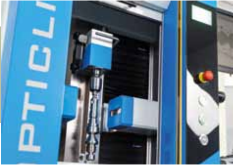
Barrière immatérielle intégrée pour la protection de l'opérateur conformément aux normes de sécurité internationales
