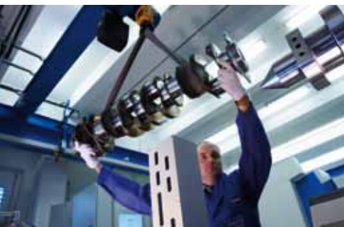
Utilisation en fabrication, chargement d'un vilebrequin pour l'autocontrôle par l'opérateur
