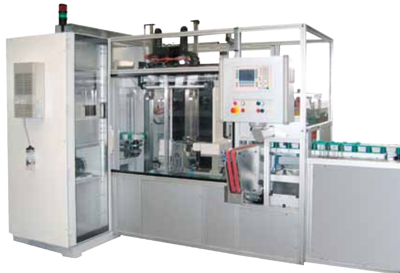
HOMMEL-ETAMIC opticlina VMS305 pour la mesure des soupapes de moteur, intégré dans une installation de fabrication
