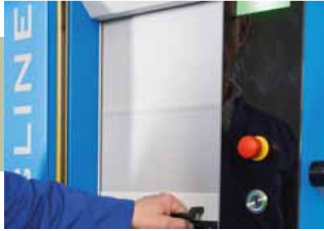
Volet roulant intégré contre les effets extérieurs perturbateurs (en option)
