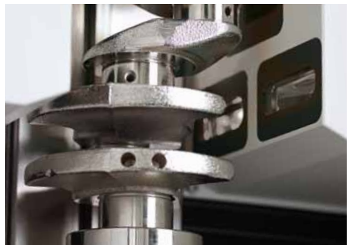
Mesure de vilebrequins avec le modèle HOMMEL-ETAMIC opticlina C1023-75AE
