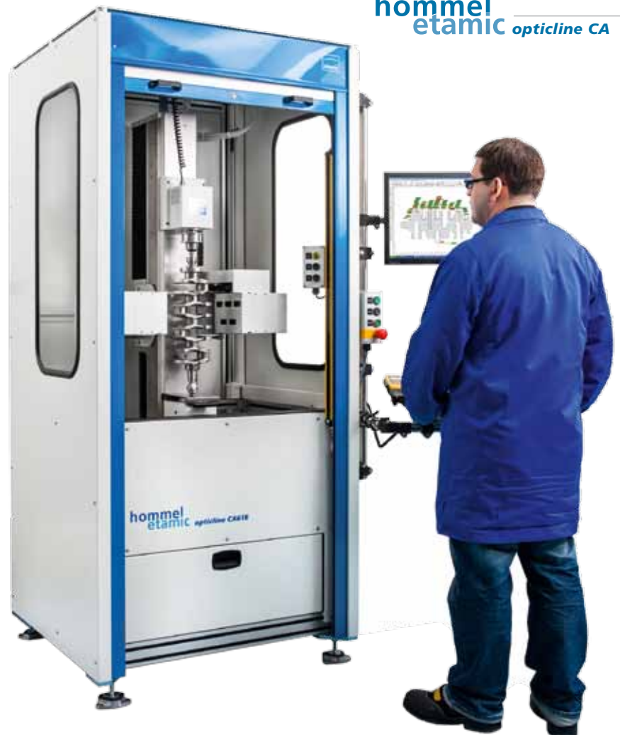
HOMMEL-ETAMIC optiline CA618 pour l'autocontrôle de l'opérateur
