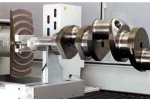
HOMMEL-ETAMIC opticline WMS, solution en version horizontale avec application vilebrequin
