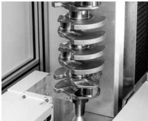
HOMMEL-ETAMIC opticlina CA618-AE pour la mesure des vilebrequins
